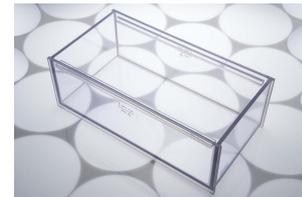
Водяная баня из поликарбоната, выдерживает температуру до +50°C, прочная, легко чистится, подходит для MIXdrive 6/15/60, а также MIXdrive 1/1 eco/1 XS, подходит для погружных термостатов (нагрев/охлаждение), легкая очистка, точное позиционирование мешалки в случае использования мешалки под ванной.
