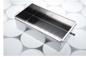
Приспособление для погружных термостатов (нагрев/охлаждение), простота очистки, возможность сварки и электрополировки, ребро в форме ручки, встроенный дренаж делает слив жидкости простым и безопасным, точное позиционирование мешалки в случае использования мешалки под ванной. Отметка точки перемешивания внутри ванны, левый/правый упор для оптимального позиционирования термостата (циркуляционный насос) для использования с MIXdrive 6 и соответственно. МИКСдрайв 15.
