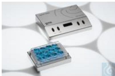
Сверхплоская, износостойкая магнитная мешалка с 24 положениями для перемешивания, подходит для 24-луночных микротитровальных планшетов.
