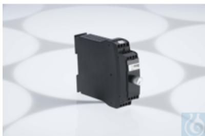
Оптимизированный по цене блок управления для установки на DIN-рейку (электрические шкафы) для малых и средних объемов и подключения одного привода перемешивания MIXdrive, с потенциометром для включения / выключения и регулировки скорости. Блок управления с мощностью перемешивания 10 Вт, диапазоном скоростей от 100 до 1200 об / мин, SoftStart для надежного захвата / центрирования и безопасного ускорения мешалки.
