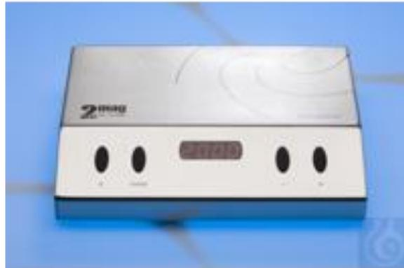
Мощный блок управления с интерфейсом RS232 для подключения до 2 приводов перемешивания MIXdrive, мощная мощность перемешивания 40 Вт, широкий диапазон скоростей от 100 до 2000 об / мин, перемешивание без рывков также на низких скоростях, регулировка мощности (8-ступенчатая) для высокая мощность при больших и вязких количествах перемешивания и пониженная мощность для непрерывной работы без нагрева, например, в инкубаторах.
